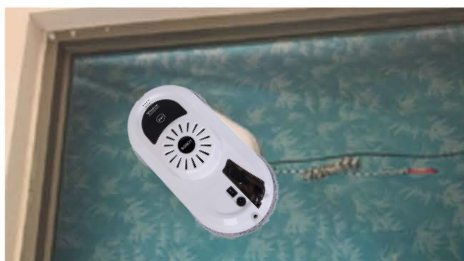
Поместите устройство на стекло. Проверьте, прилипло ли устройство к стеклу, прежде чем отпустить его.
